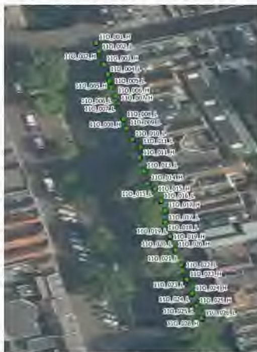
Figuur 2 locaties prisma's aan werfmuur rak 11 oost
